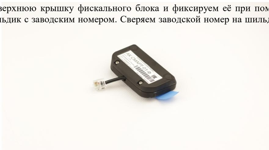
При помощи 2-х стороннего скотча прикрепляем фискальный блок к нижней части терминала NEW POS 8210, подсоединяем разъем кабеля фискального блока в гнездо RS-232.
