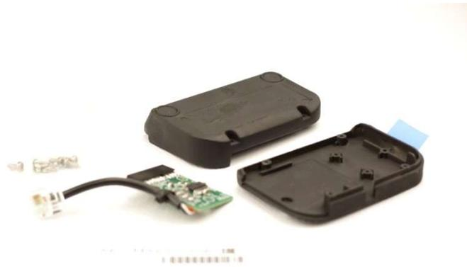
Закрепляем плату управления с кабелем при помощи 3-х винтов на основании фискального блока
