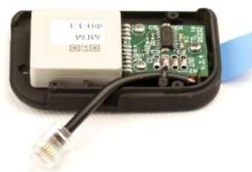
Закрываем верхнюю крышку фискального блока и фиксируем её при помощи 4-х винтов, устанавливаем шильдик с заводским номером. Сверяем заводской номер на шильдике с номером в паспорте на ККТ.
